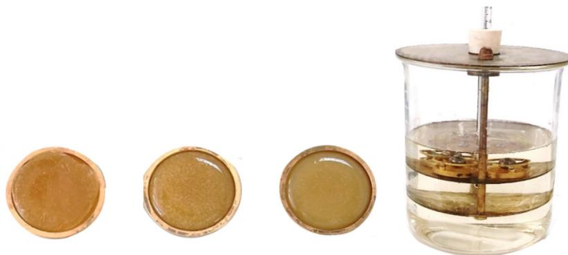
**Figura 11.** Análisis de Ring y Ball de colofonia/biosílice.
