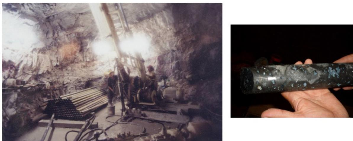
**Figura 2.** Barrenación de diamante en el interior de una obra minera y trozo de muestra obtenida (foto de los autores).
