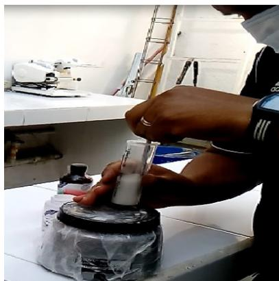
**Figura 4.** Mezcla final del líquido y polvo de PMMA.
