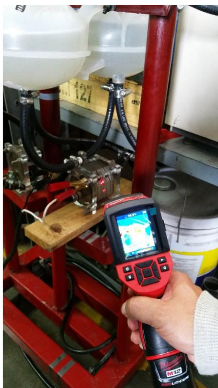
**Figura 4.** Cámara termográfica usada para obtener los mapas de temperatura de la celda de hidrógeno.
