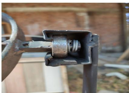
**Figura 6.** Vástago, balero y riel del sistema de desplazamiento. Imagen propia.
