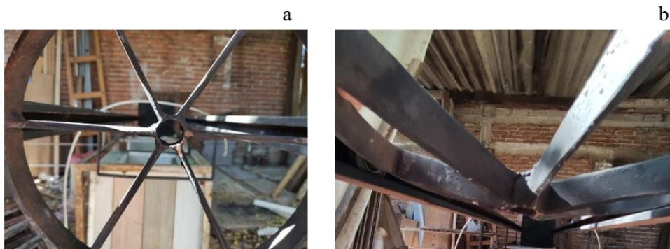
**Figura 5.** Muestra de las 6 navajas (a). Posición cónica de navajas (b). Imagen propia.
