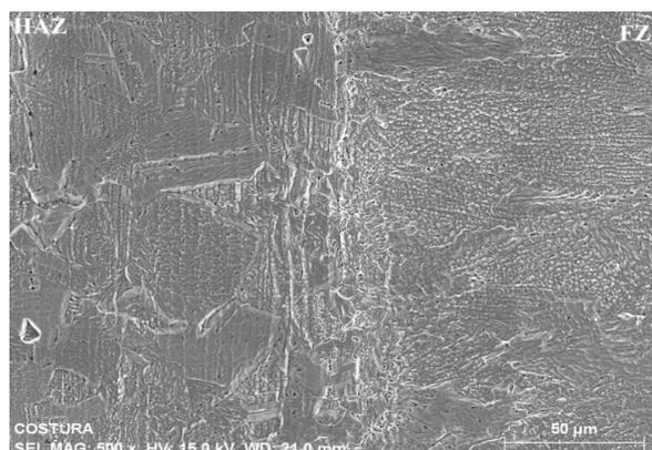
**Ilustración 10.** Micrografía a 500X de la zona de afectación térmica (HAZ) y zona de fusión (FZ), mostrando una estructura austenítica y dendrítica.
