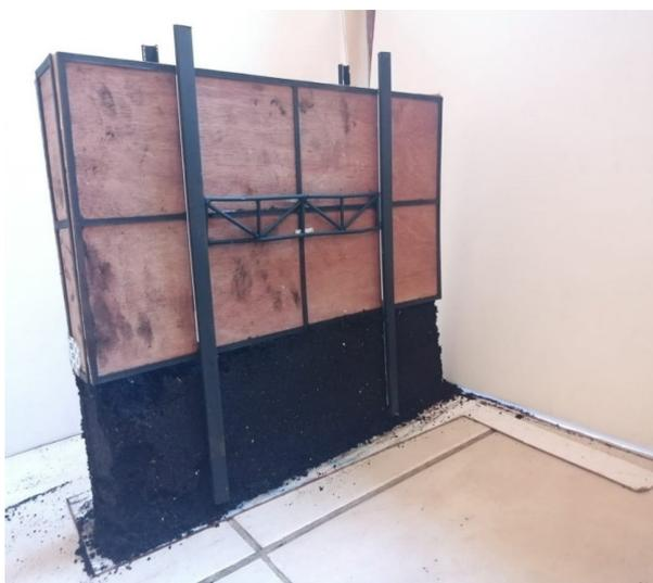
**Figura 14.** Prueba de compactación de tierra dentro de la maqueta escala 1:18.
