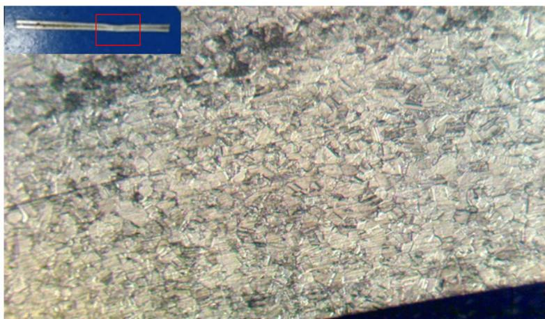
**Ilustración 6.** Unión inadecuada de placas de acero inoxidable AISI 304 por medio del proceso RSW.
