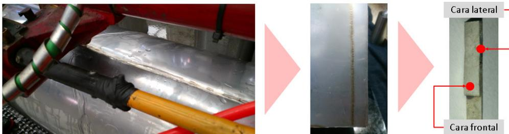
**Ilustración 4.** Ejemplo del seccionamiento de las muestras dos a cinco para analizar (Se toma como ejemplo el proceso RSEW).
