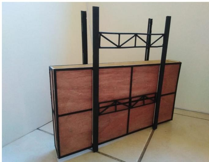
**Figura 12.** Maqueta a escala del tapial deslizable.
