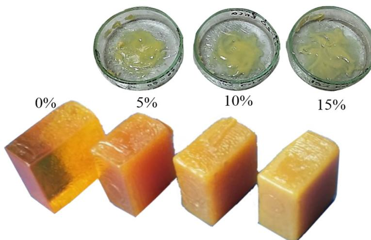
**Figura 8.** Material compuesto colofonia/biosílice.
