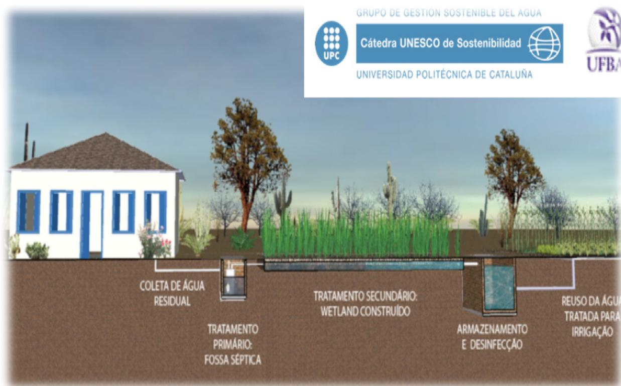
Los humedales son alternativas de tratamiento de aguas de forma natural, dando de manera artificial las condiciones que favorezcan el proceso de depuración de las aguas residuales.
