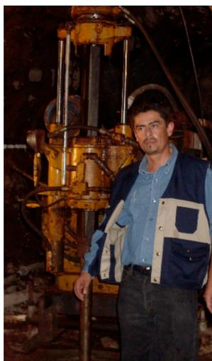
**Figura 3.** Equipo para determinación de esfuerzos *in situ* en una obra subterránea (foto de los autores).
