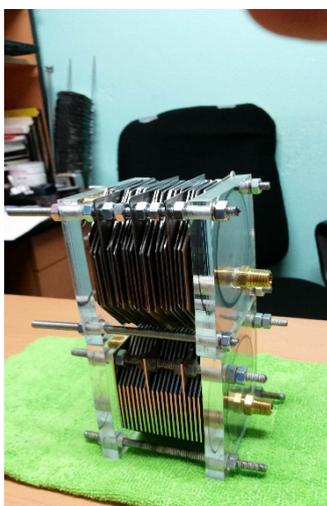
**Figura 1.** Celda de generación de hidrógeno.
