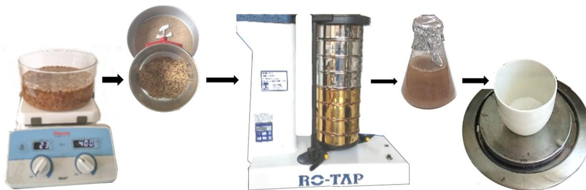
**Figura 5.** Proceso de obtención de biosílíce a partir de la cáscara de arroz (CA).
