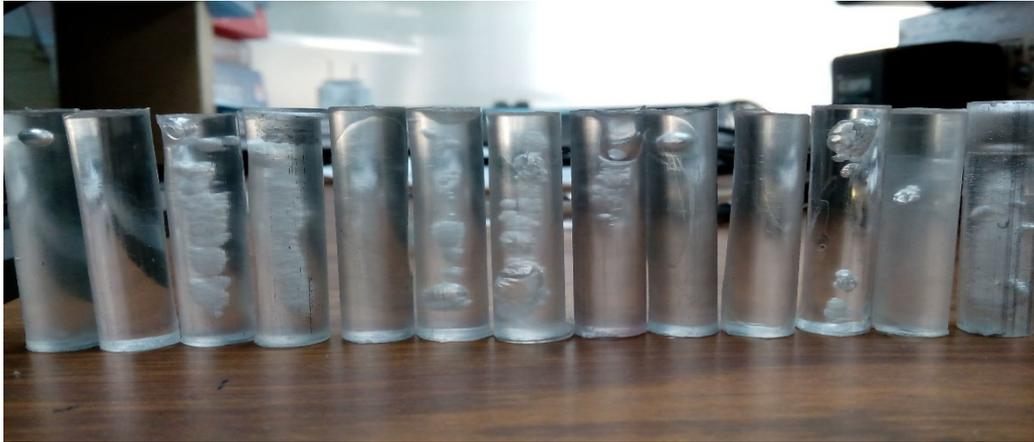
**Figura 12.** Proceso de mala fabricación del material PMMA.
