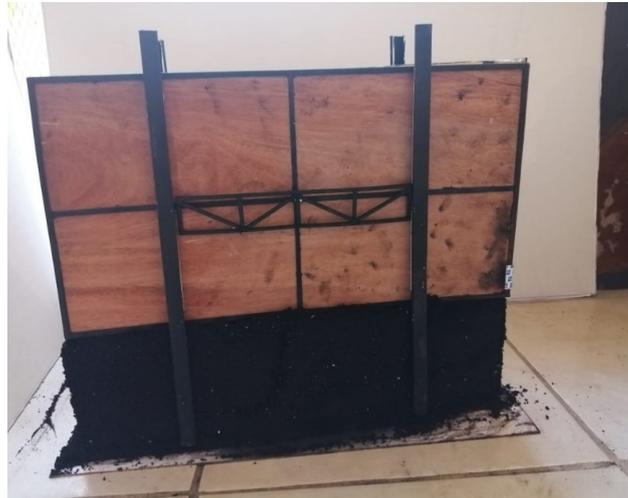
**Figura 15.** Prueba de compactación de tierra dentro de la maqueta escala 1:18.
