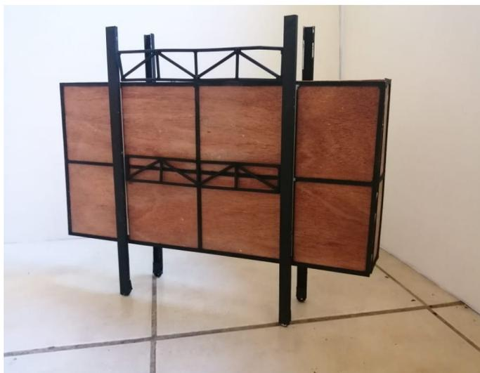
**Figura 13.** Deslizamiento vertical de maqueta de tapial deslizable.
